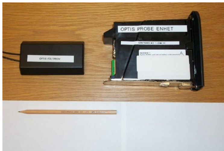
Obrázek 24 GSP a GSP moduly instalované v testovacích vozidlech za využití jedné kombinované antény. Cena těchto modulů nebyla vyšší než 500 Euro na jedno vozidlo
