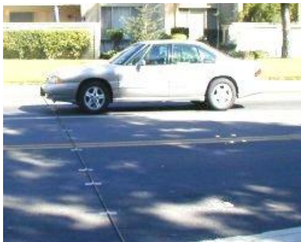
Obrázek 1 Pneumatický sčítač, na obrázku je vidět pneumatická tlaková hadice uložena napříč vozovkou.
